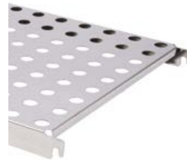
Lochboden 1.0 mm stark Ø 24 mm Lochgröße Teilung 50 mm
