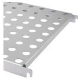
Lochboden 1.5 mm stark Ø 24 mm Teilung 50 mm
